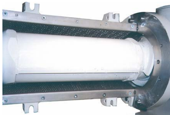
Vista del rotore. Drum rotor detail.
