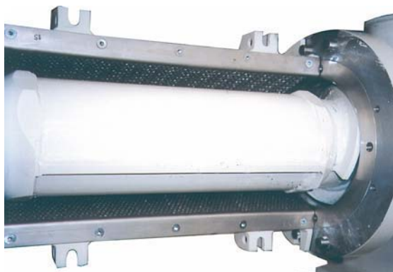
Vista del rotore. Drum rotor detail.
