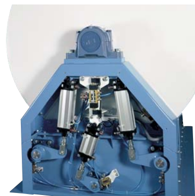
Gruppo pneumatico di apertura e chiusura scarico con blocco di tenuta
